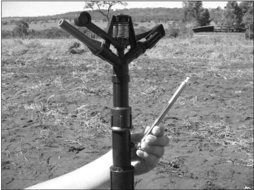
Figura 57. Medição da pressão de operação na base do aspersor.
