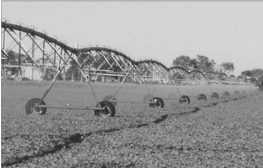
Figura 26. Linha lateral de um pivô central.
