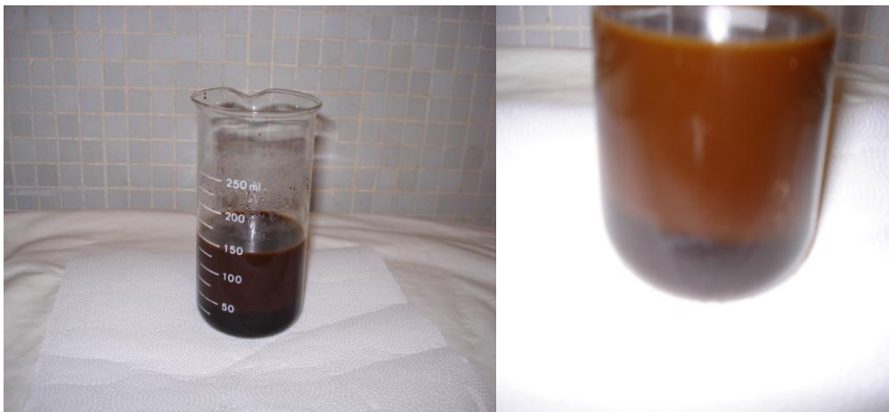
Figura 12 – Borra de café e etanol após encubação e separação de fases.
