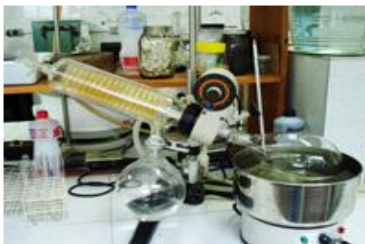
Figura 10 – Evaporador rotativo a vácuo- separação de solvente dos extrativos.
