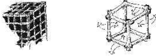
FIGURA 5.1 – Estrutura de um material poroso e seu mecanismo de dissipação de energia sonora
