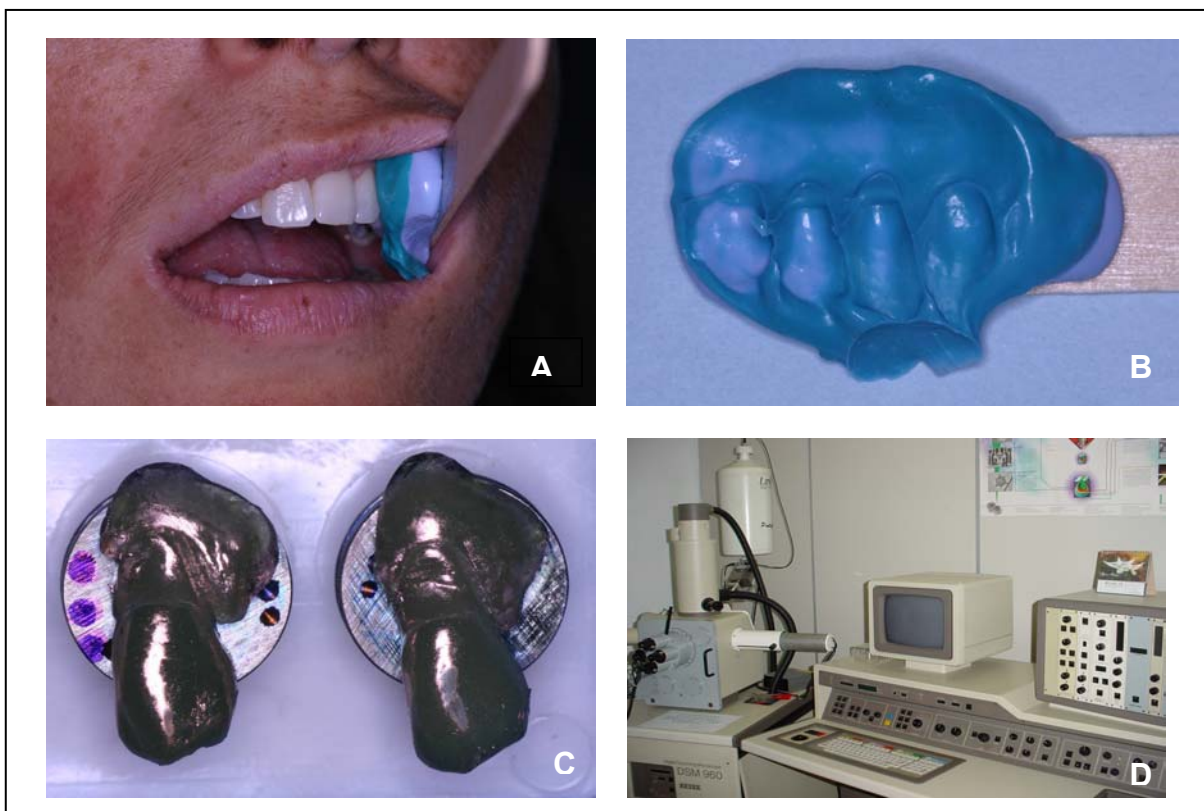
Figura 3 - A – Moldagem com silicone de adição dos dentes sensíveis. B – Aspecto da moldagem. C – Troquéis de resina epóxica após a metalização. D – Microscópio eletrônico de varredura.
